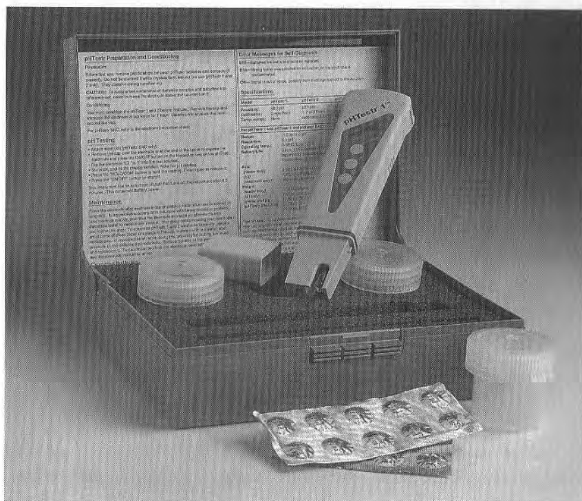
Trousse de mesure du pH: pH-mètre et solutions pour la calibration.
