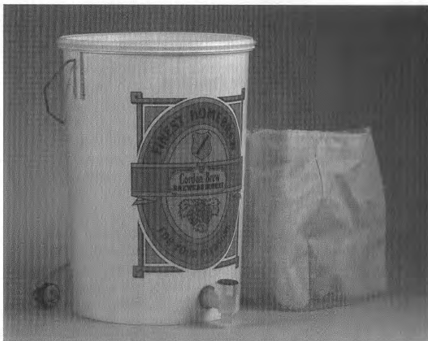
Bouilloire électrique à thermostat (vue de l'arrière montrant le robinet) et sac en nylon qui se place à l'intérieur. Le sac est fixé au haut du seau par trois crochets ou repose sur un faux fond perforé.
